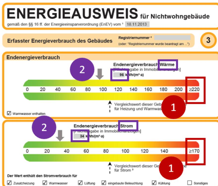
Schritt 1: Berechnung der absoluten Effizienzklassengrenzwerte der Immobilie für Wärme und Strom
